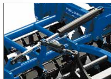
Le réglage de profondeur se fait hydrauliquement (en option) depuis la cabine grâce aux vérins maître/esclave.
