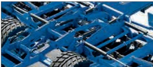
Hydraulische Einstellung der Arbeitstiefe von der Kabine aus über Geber/Nehmer Zylinder (Option).
