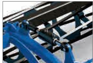
Hydraulische Einstellung der Arbeitstiefe von der Kabine aus über Geber/Nehmer Zylinder (Option).
