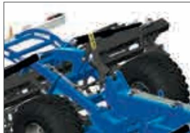
Die Tiefeneinstellung des Nachläufers erfolgt hydraulisch.
