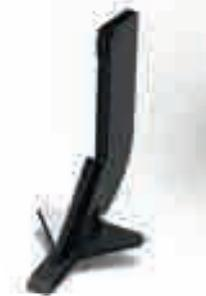
Gerader NT-Zinken mit Grindelschutz, Meißel und abnehmbarer Finne.
